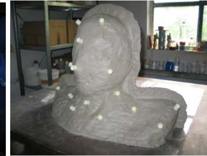
delilna stena iz gline in distančniki za debelino oporne kape
