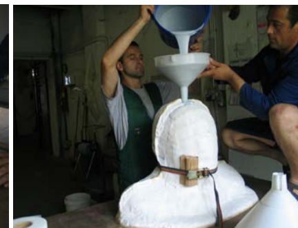
vmesni prostor med originalom in kapo zalijemo z Modrinom
