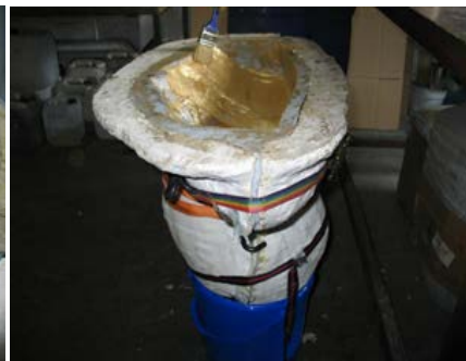
ponovno sestavimo Modrin in kapo iz Kremenita in zalijemo s Solido
